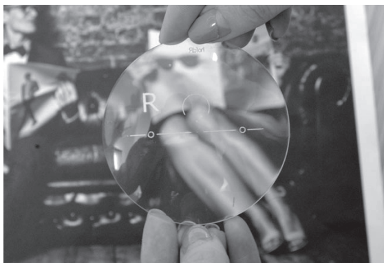
Рис. 8. Бипризматическая прогрессивная линза с невидимой «линией спечения», полученная с помощью технологии Free Form
