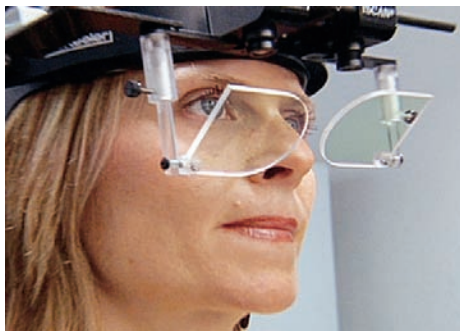
Рис. 3. Оценка качества мягких торических линз за счет моделирования ситуаций реального мира с помощью системы мониторинга движения глаз (Eyetrack Monitoring System)
