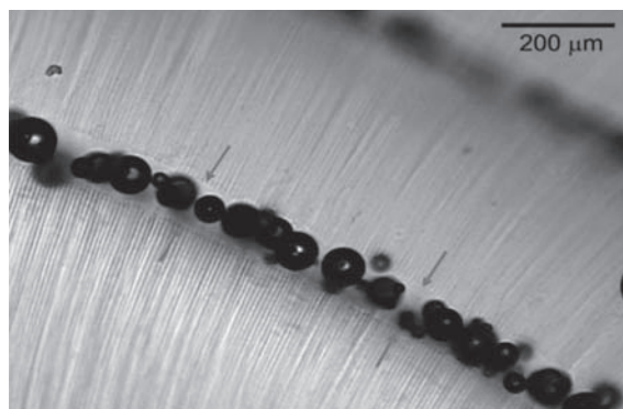
Рис. 1. Разрез капсулы хрусталика свиного глаза при параметрах: энергия импульса 10 мДж, частота импульса 50 кГц [21]
