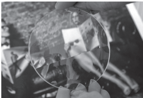
Рис. 9. Бипризматическая прогрессивная линза с резкой линией среза, полученная с помощью традиционной технологии обработки поверхности
